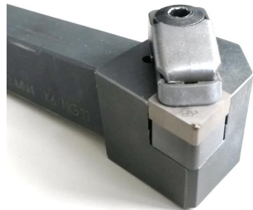
Bild 1: Drehmeißel mit Wendeschneidplatte aus NbC-basiertem Schneidstoff
